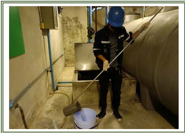
รูปที่ 3-3 การเก็บตัวอย่างคุณภาพน้ำทิ้ง บริเวณน้ำเสียก่อนเข้าสู่ระบบบำบัดน้ำเสีย
